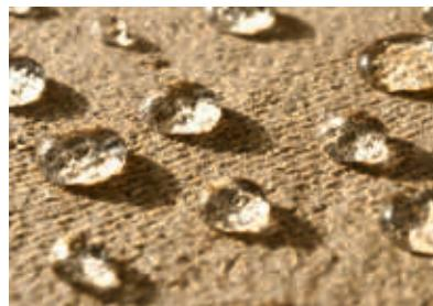
Sur le chantier, les panneaux peuvent être exposés aux intempéries pendant 4 semaines avant la pose de l'enduit.
