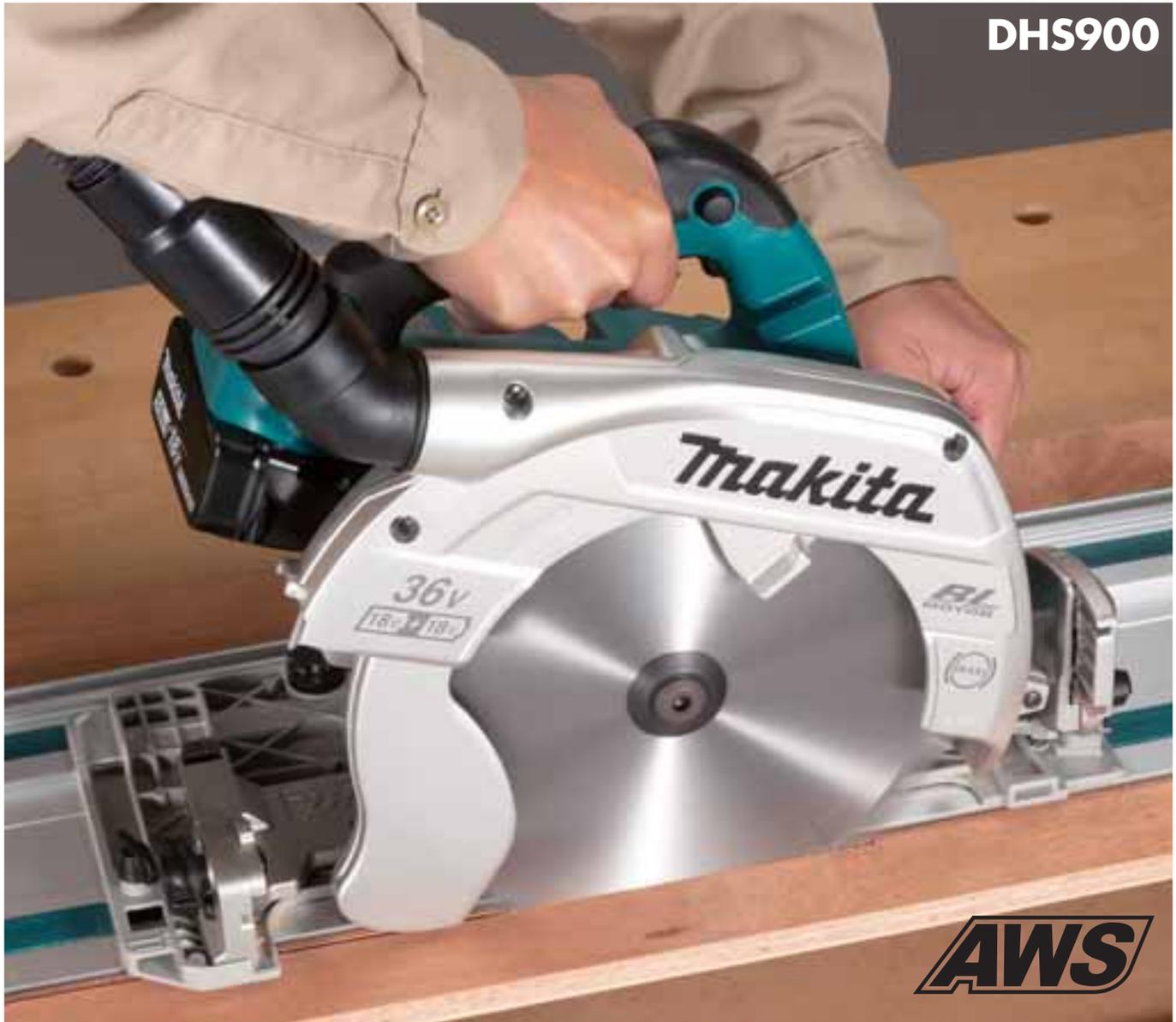
Première scie circulaire à batterie de Ø 235 mm, pour une capacité maximum de 85 mm
