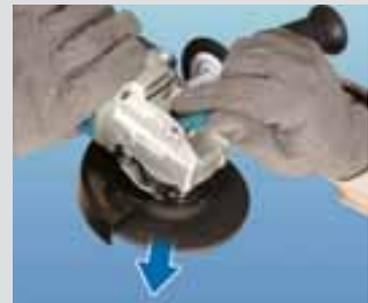
Pour les retirer, il suffit de tirer le levier
