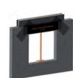
Renfort à l'aide d'une trame
