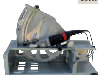
Scie sur table ALKERN (220 V, nécessite un groupe électrogène de 3 KW mini)
