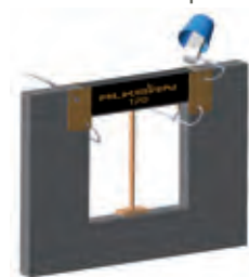
Sceller les côtés du coffre au mortier
