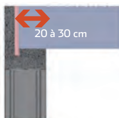
Planéité de la dalle sur 20 à 30 cm
