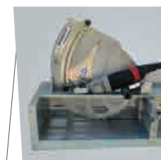
5- Scie sur table Alkern (220 V, nécessite un groupe électrogène de 3 KW mini)
