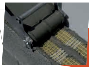
2. Application d'une 2 ème couche de colle au-dessus de l'armature
