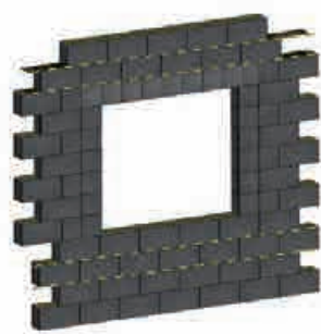
Armatures intégrées dans les 2 joints, au-dessus et au-dessous de l'ouverture
